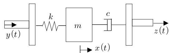
6.[6점] 건물 3층 바닥에 그림과 같이 설치된 전기 모터가 2,400 rpm의 회전속도로 가동된다. 이 모터는 전체 질량 40 kg 중 10%인 4 kg의 편심질량을 갖고 있고, 편심 거리가 회전축으로부터 80 mm이다. 강성 k인 스프링 4개가 모터를 받치고 있어서 등가 스프링 상수는 80,000 N/m이다. (뒤의 스프링 2개는 도시되지 않음) 스프링의 감쇠는 무시 할 만하다.
