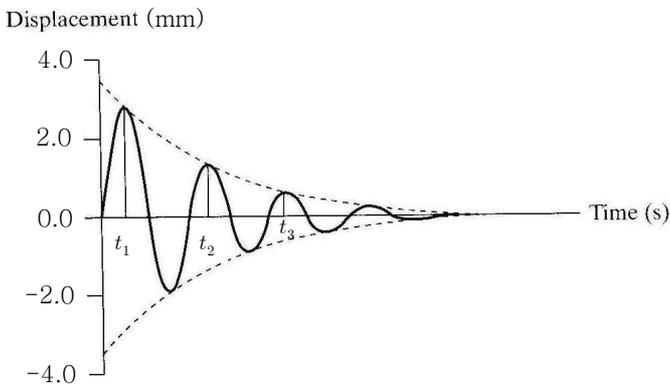
(a) 이 시스템을 구성하는 감쇠기(damper)의 감쇠비(damping ratio)를 구하라.
