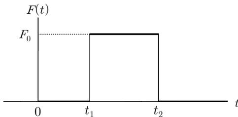
(a) 감쇠계( $\zeta > 0$ )인 경우에, 0과  $t_1$ 시점 사이에서 관찰되는 응답 변위  $x_1(t)$ 와  $t_1$ 시점과  $t_2$ 시점 사이에 관찰되는 응답 변위  $x_2(t)$  (위의 응답 식을 사용함.)
