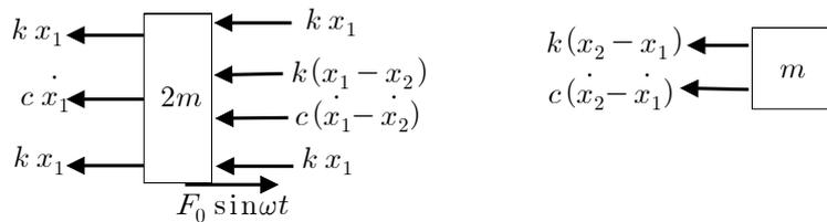
(b,c)  $2m \ddot{x}_1 = -4kx_1 - k(x_1 - x_2) - c\dot{x}_1 - c(\dot{x}_1 - \dot{x}_2) + F_0 \sin\omega t$
