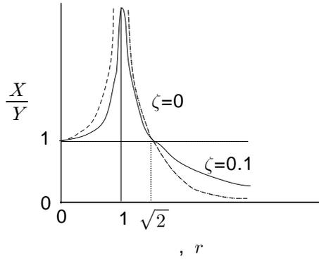
$$(b) \quad : k \quad , \quad \omega_n \quad , \quad r = \frac{\omega}{\omega_n} \quad 0 \quad \frac{X}{Y} \quad 1$$
