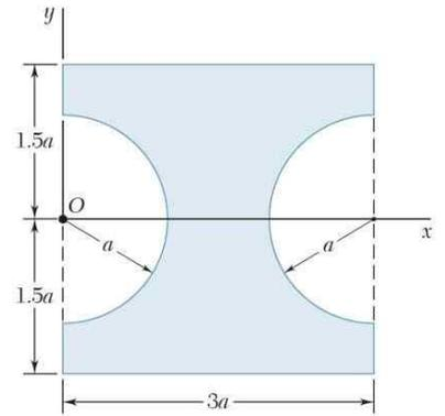
(a) 이 단면의  $x$ 축에 대한 면적 관성모멘트(area moment of inertia)  $I_x$ 를 구하고,  $x$ 축에 대한 회전 반경(radius of gyration)  $k_x$ 를 구하여라.
