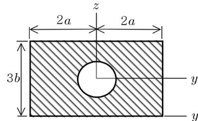
(a) 도심을 지나는  $y$ 축에 대한 질량 관성모멘트(mass moment of inertia)  $I_y$ 를 구하고, 판에 수직이며 도심을 지나는  $x$ 축(도시되지 않음)에 대한 질량 관성모멘트  $I_x$ 를 구하라.
